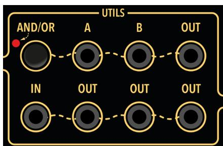
Además, incluye un mezclador booleano que permite combinar 2 señales de entrada, generando como resultado su operación OR o AND. Para utilizar la función AND, activa el interruptor (luz encendida).
